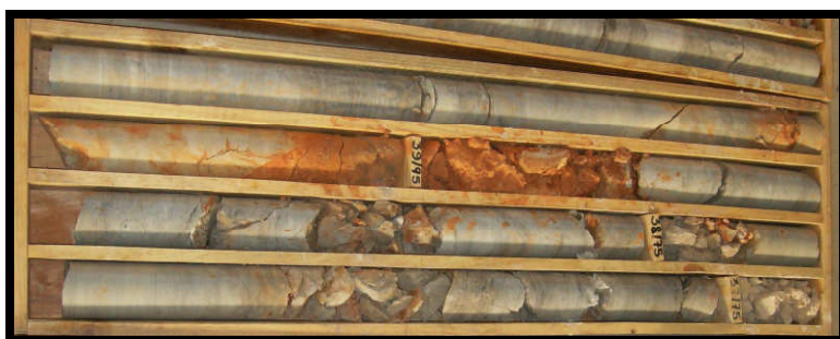
Fig. 12 - Preenchimento argiloso das fracturas.
