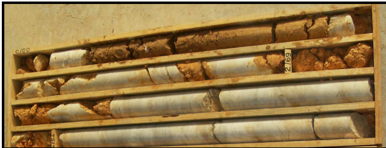
Fig. 13 - Solo que ocorre no início da sondagem.
