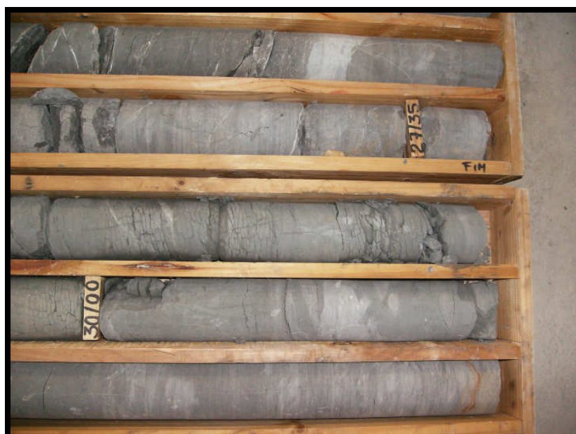
Fig. 16 – Marga, 24 horas após ser molhada
